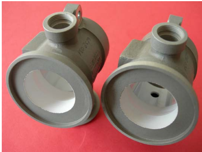
Traitement par la technologie d'oxydation micro-arcs de corps LTS 6232-031 (Photo GIT)
