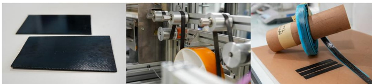
Illustration des travaux en cours autour des procédés RTM et imprégnation : plaques carbone/phthalonitrile réalisées par procédé RTM (1), renforts carbone/phthalonitrile obtenus par procédé d'imprégnation (2,3)
