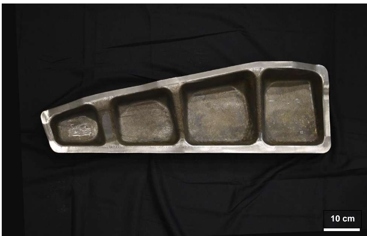
Démonstrateur en alliage de titane TA6V en fin de gamme de transformation à chaud, après ébavurage – L = 800mm, masse : 32kg
