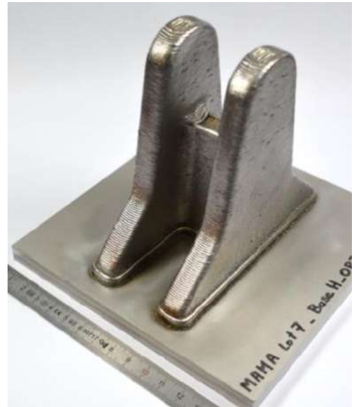
Démonstrateur de ferrure 15-5PH après dépôt LMD-poudre par l'IRT Saint Exupéry
