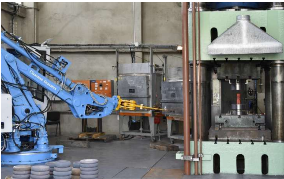
Plateforme commune de recherche dédiée au forgeage/matriçage – Presse de 1000 tonnes et manipulateur de pièces chaudes – (Aubert & Duval et IRT Saint Exupéry)
