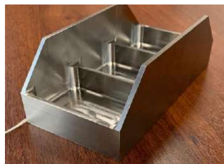
Démonstrateurs TA6V matriçés sur la plateforme de recherche (avant et après usinage)
