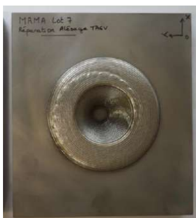
Démonstrateur TA6V après rechargement par LMD-poudre par l'IRT Saint Exupéry
