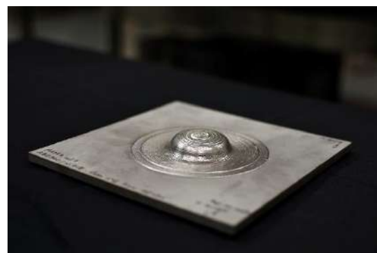
Reconstitution de la forme de centrage d'outillages de matriçage (aciers et superalliages à base de nickel) par LMD-poudre par l'IRT Saint Exupéry & OPT'ALM
