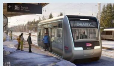
**Drais** est un petit train modulaire entièrement électrique de 30 voyageurs assis destiné aux lignes ou aux segments de lignes d'une centaine de kilomètres à faible trafic qui offrira une souplesse d'usage comme des arrêts « à la carte ». Totalement propre, il permettra d'augmenter la fréquence de passage sur ces lignes et d'offrir une solution pour permettre des réouvertures de ligne.
