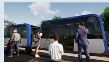
**Taxirail** est un projet d'un petit autorail de 15 places assises (40 places au total) conçu pour circuler en mode autonome à l'électricité grâce à des batteries rechargées par un prolongateur d'autonomie d'origine thermique à base de GNV (gaz naturel pour véhicules) dans un premier temps. Son autonomie avoisinera 600 kilomètres et sa vitesse de croisière variera entre 90 et 110 km/h même s'il sera capable d'atteindre 135 km/h. ■
