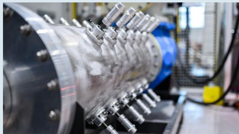
Maquette de vieillissement simultané de 24 échantillons de matériau DC et AC.
