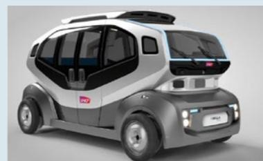
**Flexy** est un projet de navette bi-mode de 14 places assises, mobile électrique capable de rouler à la fois sur rail et sur route.
