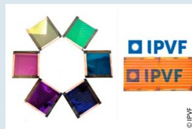
Mini-modules de pérovskite de 16 cm² semi-transparents colorés fabriqués à l'IPVF.
