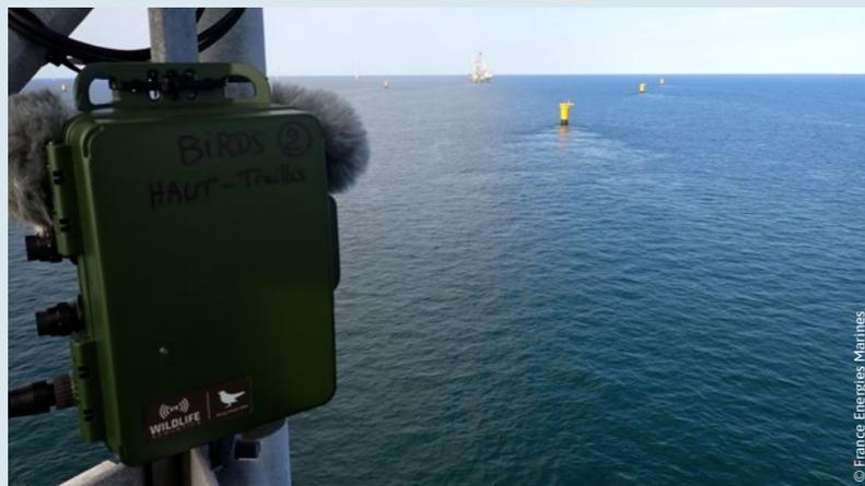
Déploiement d'enregistreurs acoustiques pour le suivi des oiseaux sur la plateforme
