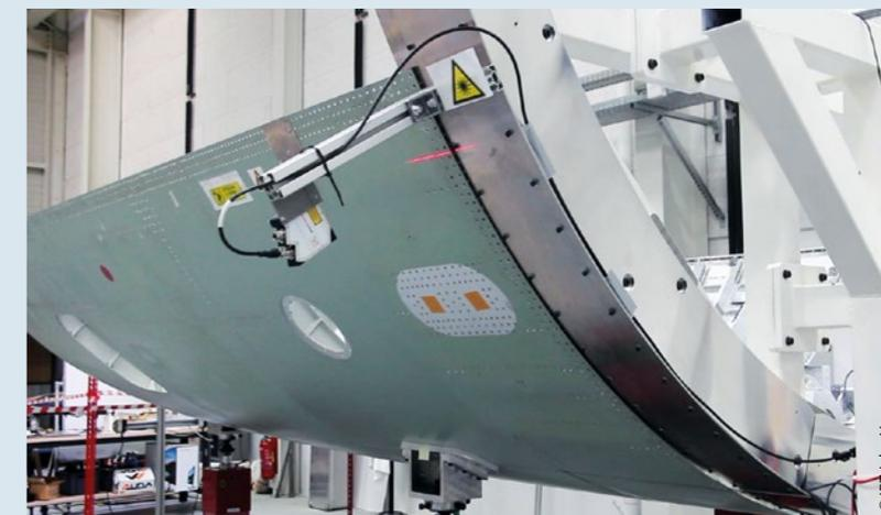
Assemblage automatisé d'éléments de fuselage par une commande référencée capteurs - Projet HAPPY
