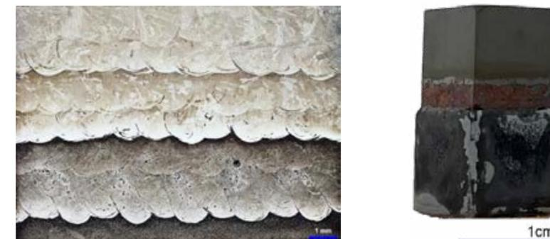
Exemple de matériaux à gradient développés par LMD (LaserMetalDeposition) et caractérisés dans le cadre de la thèse d'Agathe Curnis (encadrement Aurélien Prillieux - IRT, Ioana Popa - ICB, Sébastien Chevalier- ICB)
