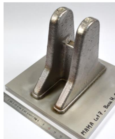
Démonstrateur de ferrure 15-5PH après dépôt LMD-poudre par l'IRT Saint Exupéry
