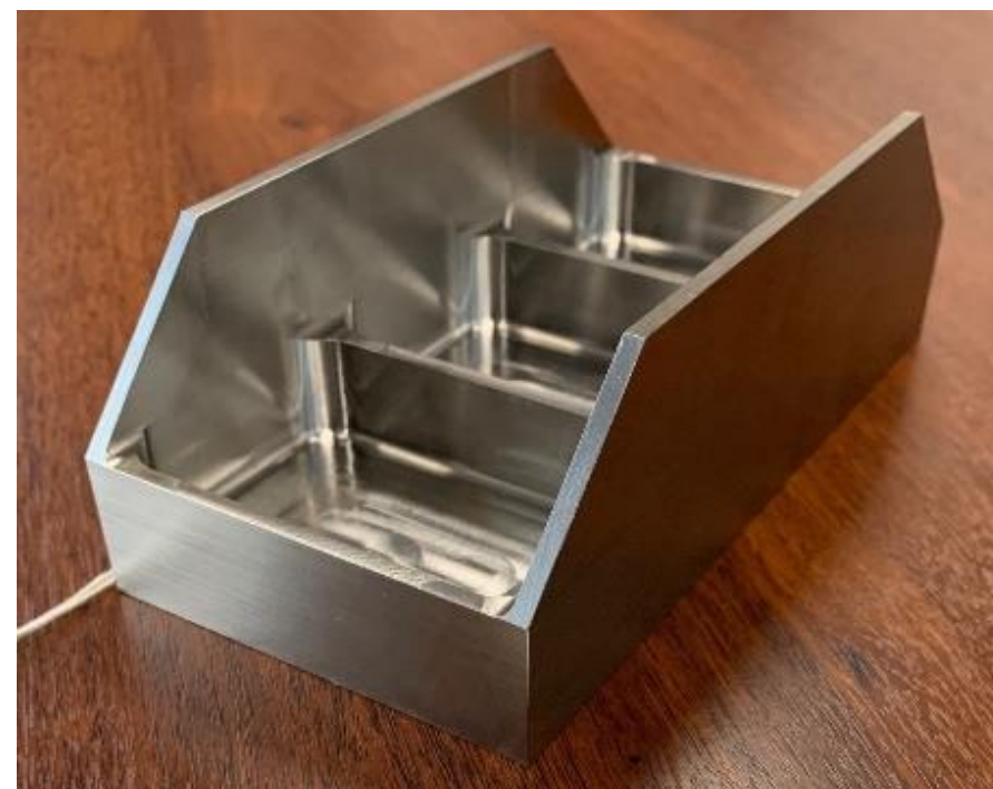
Démonstrateurs TA6V matriçés sur la plateforme de recherche (avant et après usinage)
